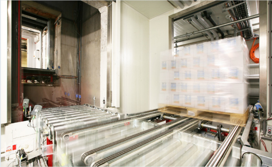
Hubtische überwinden die Niveaudifferenzen zwischen den einzelnen Lagerbereichen, hier in der Passage zwischen Neu- und Bestandsbau (rechts).
