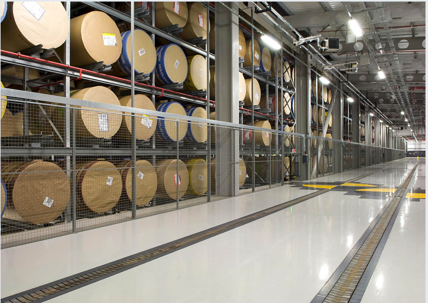
In den 23 Meter hohen Hochregalsystemen lagern bis zu 3.283 Druckrollen. Die HRL sind klimaoptimiert angelegt, um Beschädigungen des Papiers zu vermeiden.
